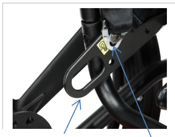
Anneau de fixation arrière avec Ceinture abdominale commerciale ancrée au fauteuil roulant
